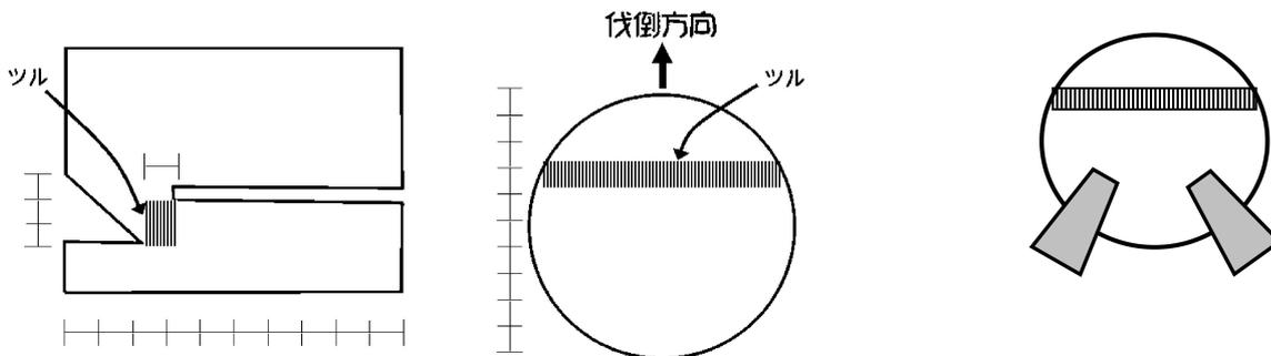
※ツルとは受け口と追い口の中の切り残しの部分で、狙った方向に倒すために必要なもの。木が倒れるときツルが「蝶つがい」のような役目を果たす。ツルの高さが「低い」または幅が「薄い」場合は、ツルの働きは弱くなる。ツルのバランスが崩れていると伐倒方向が変わる。
